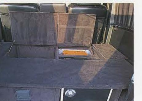
Hinter den Rücksitzen des Geländewagens finden in eigens entwickelten Staufächern eine zweite Batterie für den gesteigerten Strombedarf sowie ein einbruchsicherer Safe Platz.
