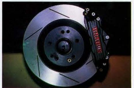
**Alle Komponenten der BRABUS-Hochleistungsbremsanlage.**
