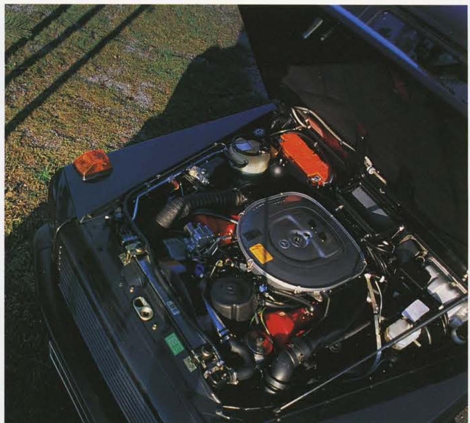
Kernstück des in Handarbeit gefertigten Fahrzeugs ist ein auf 5,6 Liter Hubraum vergrößerter V8, der 280 PS leistet und ein maximales Drehmoment von 435 Nm bei 3000 U/min bietet.
