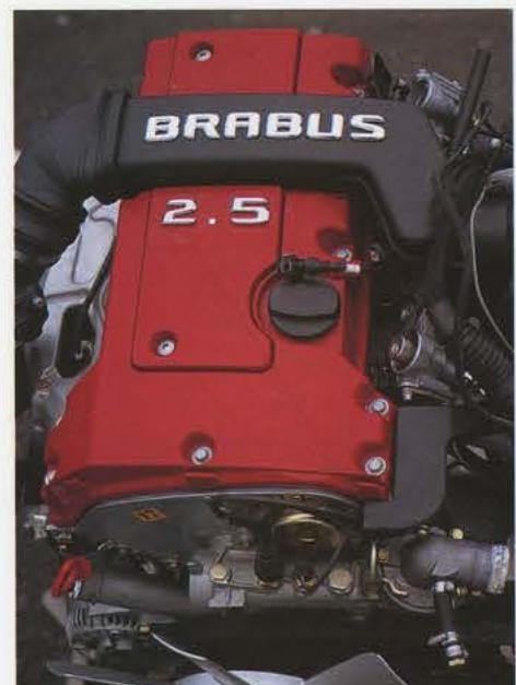
Mit vier Ventilen können die Vierzylinder nochmals freier durchatmen. Schon die erste Tuningstufe hinterläßt mit immerhin 29 Mehr-kW gegenüber dem 2.0-Liter-Serienmotor einen äußerst agilen Eindruck.
