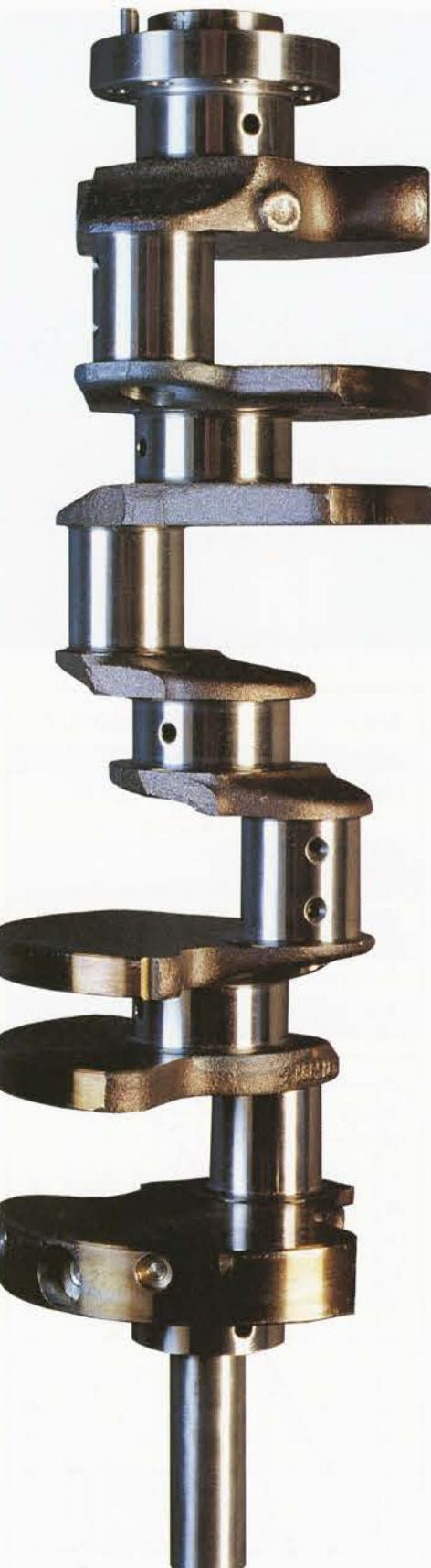
Der zweite Fünfliter-Achtzylinder aus dem Haus Mercedes unterscheidet sich vom Vorgänger durch die um 16,5 Millimeter geringere Blockhöhe. Beim neuen V8 mit kompaktem Block war es besonders schwierig, die BRABUS-Langhub-Kurbelwelle mit 94,8 Millimeter Hub unterzubringen. Es ist dennoch perfekt gelungen. Dieser V8 begeistert durch besonders spielerische Leistungsentfaltung und im ganzen Drehzahlbereich durch eine enorme Drehmomentelastizität.
