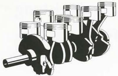
Der ursprünglich mit fünf Liter Hubraum ausgestattete V-8 im Mercedes 500 SL läßt sich durch die klassischen BRABUS-Tuningmethoden auf sechs Liter Hubraum (genau: 5963 cm<sup>3</sup>) aufstocken. Zusammen mit den ebenso klassischen Erweiterungs-Möglichkeiten der penibel strömungstechnisch optimierten Kanäle in den Zylinderköpfen entsteht mit dem Sechsliter-BRABUS ein kompaktes Kraftpaket mit enormer Kraft in allen Lebenslagen.
