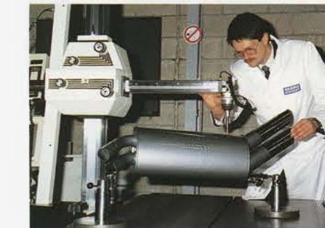
Die BRABUS-Prototypen werden mit Hilfe von CAD-Systemen mit Toleranzen von unter 0,5 mm vermessen und gefertigt.
