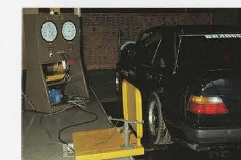
Analyse der Schalldämpfer im Fahrzeuggeräuschspektrum.
