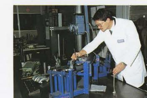
Kontrolle der Werkzeuglehre an einem Vorserienprodukt. Checking the tool gauge on a pre-production model.
