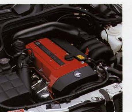
Das Ergebnis präziser Handarbeit verhilft der C-Klasse zu überlegenen Leistungen: 3,6 Liter, 24 Ventile, 285 PS, 400 Nm.
