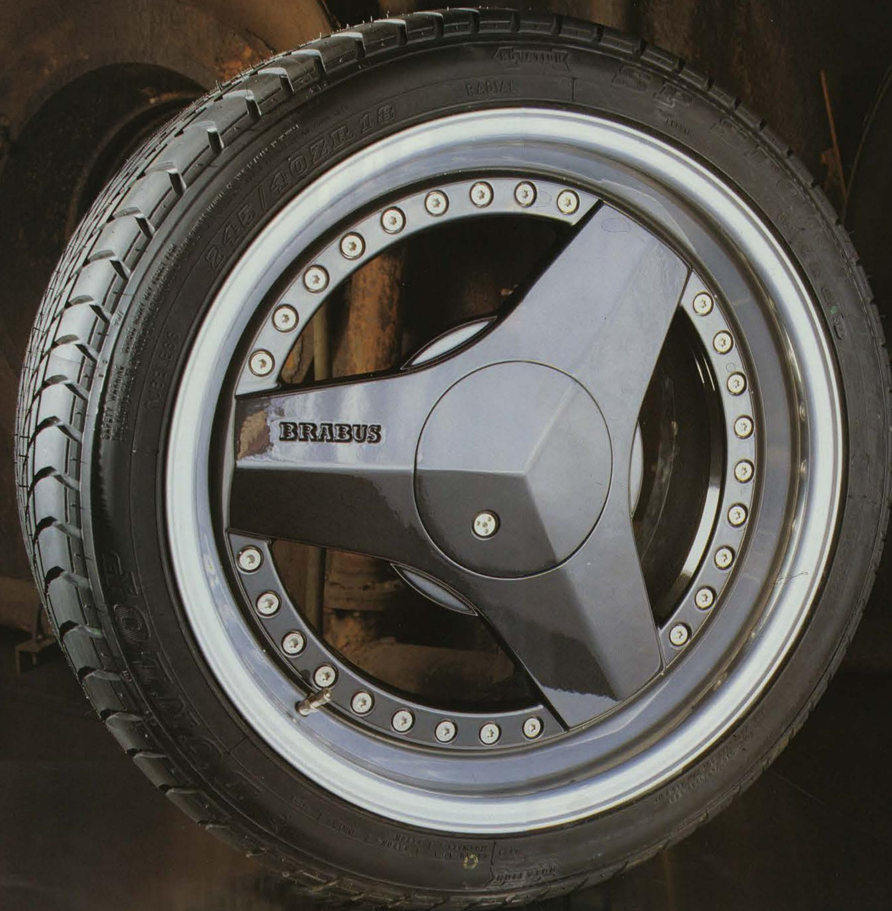
Spezielle Aluminium-Legierungen garantieren höchste Sicherheit der Materialfestigkeit. Auch extreme Belastungen können dem BRABUS Monoblock nichts anhaben (geprüfte Radlast bis zu 1.000 kg bei Monoblock III).
