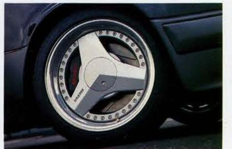
**BRABUS-Hochleistungsbremsanlage für den 400E, 500E und die 24V-Modelle.**
