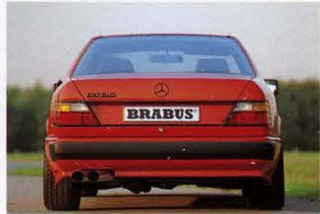
Die BRABUS-Sportauspuffanlage mit Endrohren von 76 mm Durchmesser rundet das kraftvolle Erscheinungsbild ab.
