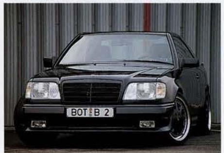
Der Frontstoßfänger aus Pur-R-Rim absorbiert eine Aufprallenergie bis zu 5 km/h.
