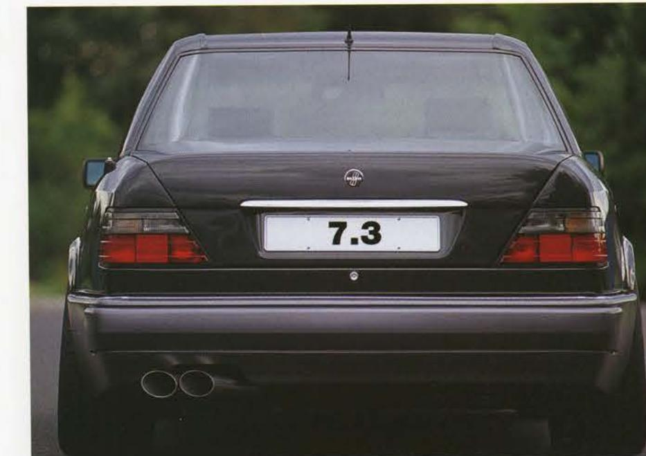
Von außen ist der BRABUS E 7.3/V12 nur an den beiden dicken Endrohren der Hochleistungsauspuffanlage und den 18-Zoll Rädern zu erkennen.
