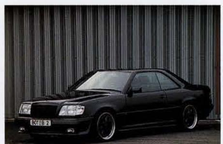
Die seitlichen Schwellerverkleidungen geben dem Fahrzeug eine sportliche Note und bewirken eine optische Tieferlegung.
