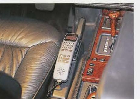
Das Autotelefon mit Freisprecheinrichtung findet Platz in einer Spezialkonsole auf dem Handbremshebel.
